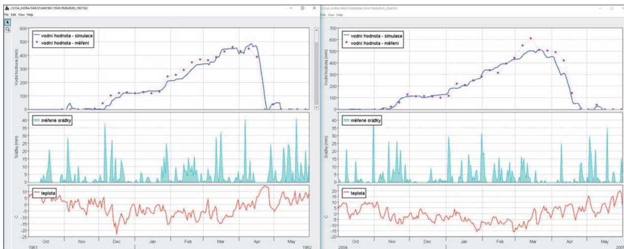
Obr. 8 Ukázka simulované a měřené vodní hodnoty (nahore), měřených srážek (uprostřed) a teploty vzduchu (dole) pro zimní sezóny 1961–1962 a 2004–2005 v prostředí editoru časových řad HEC-DSSVue.
